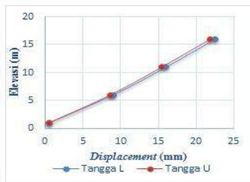
Gambar 25. Grafik Hubungan Displacement dan Elevasi (h) antar Lantai Arah Memanjang Model
