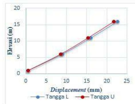
Gambar 26. Grafik Hubungan Displacement dan Elevasi (h) antar Lantai Arah Memanjang Model
